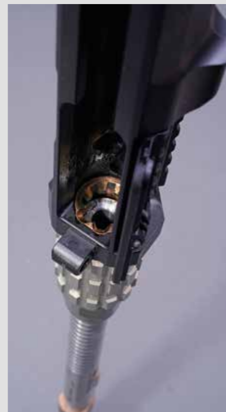
Der Lauffortsatz (Barrel Extension) ist aufwendig bearbeitet, auf Hochglanz poliert und beschichtet.
