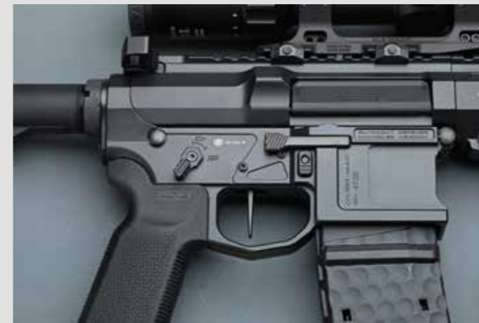
Das Griffstück ist vollständig auf beidseitige Bedienung ausgelegt.
